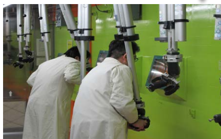
クリーンブース内での試験装置の遠隔操作
