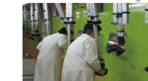
クリーンブース内での試験装置の遠隔操作
