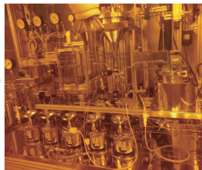
クリーンブースにある鉛セル内の ^{99\text{m}}\text{Tc} 分離・抽出・濃縮試験装置
